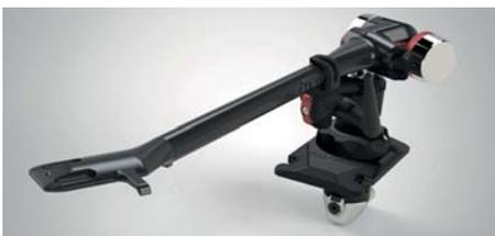
Bei der Entwicklung des höhenverstellbaren High-End-Tonarms wurden neue Gestaltungsansätze verwirklicht. Einzigartig ist das hochfeste Compound, ein Material, das eine nahtlose dickwandige Konstruktion des Rohrs bis zum Gegengewicht ermöglicht. Die berührungslose Funktion des Antiskatings ist dank einer ausgeklügelten neuartigen Anordnung von Magneten stufenlos regelbar.
