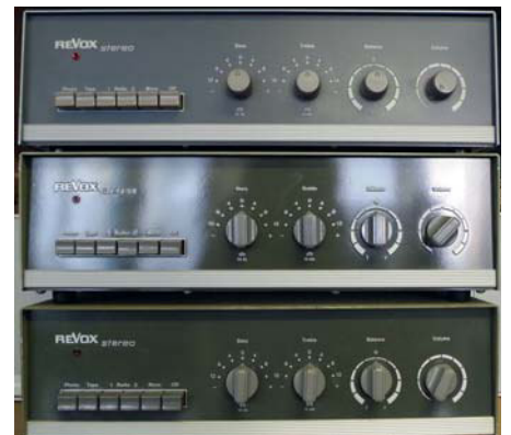
Der erste Stereovorverstärker in Röhrentechnik: Revox 40 (1961-1965)
