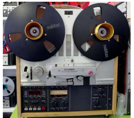
Master-Maschine Studer B67/A 80 (1970) in einer Vierkanal-Ausführung
