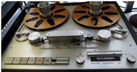
Studer-Mastermaschine A81 (1976) mit umgekehrter/deutscher Schichtlage
