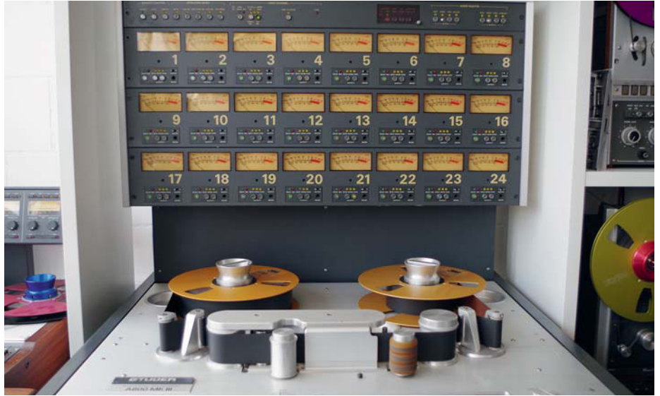
Studer-Maschine A800 MKIII (1977-1988) in einer 24-Kanal-Ausführung
