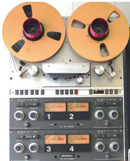
Master-Maschine Studer B67/A 80 (1970) in einer Vier-Kanalausführung
