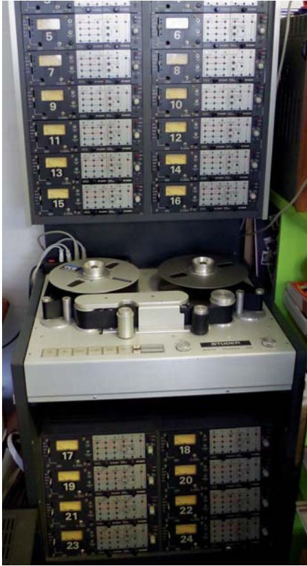
Master-Maschine Studer A 80 (1970) in einer 24-Kanal-Ausführung
