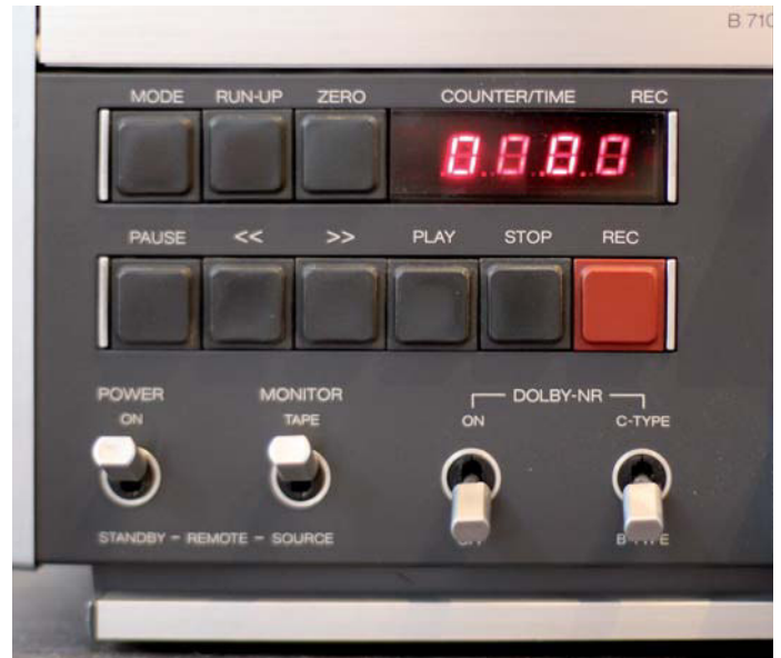
Elektronisches Zählwerk und Kurzhubtasten zur Laufwerksteuerung, Dolby-B und -C
