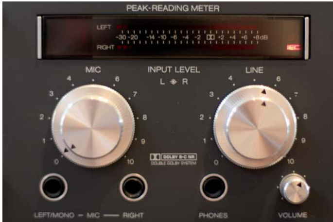
Aufnahmeregler und Klinkenbuchsen für Mikrofon und Kopfhörer
