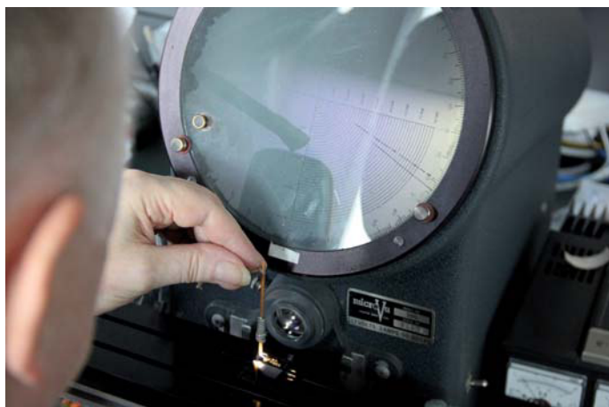
Bild 3: Profilprojektor für die Überprüfung des Nadelträgers
