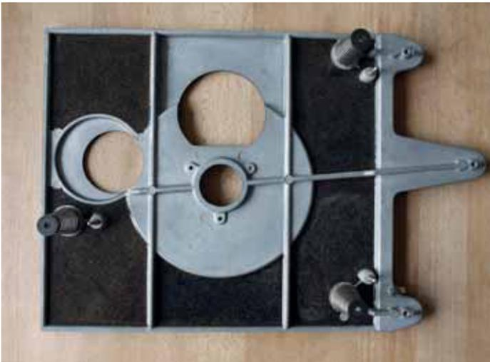
Das mit RDC verfüllte Schwingchassis von unten
