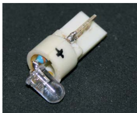
Bild 13: Zählwerk-LED mit Vorwiderstand
