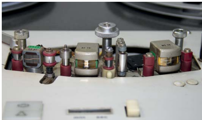
Bild 3: Tonkopfbrücke Telefunken M15 mit internationaler Schichtlage
