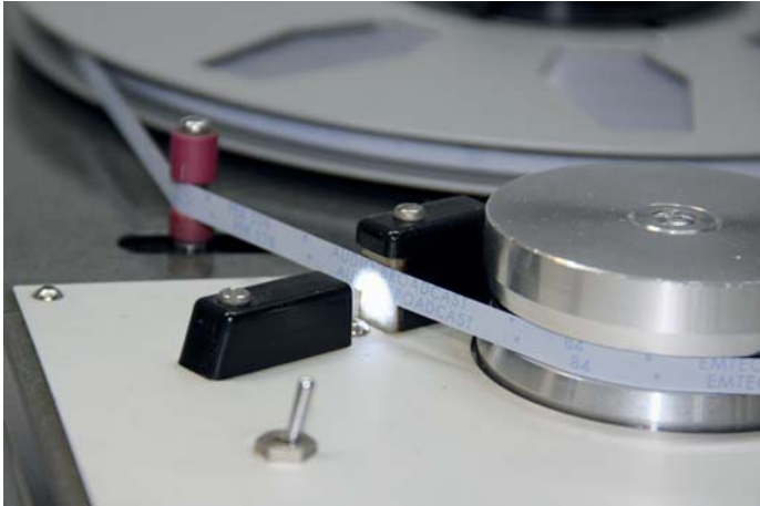
Bild 14: Lichtschranke im aktiven Modus
