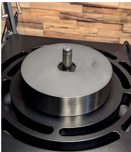
Edelstahlbasis auf der ausgefrästen Basis mit Edelstahldorn.
