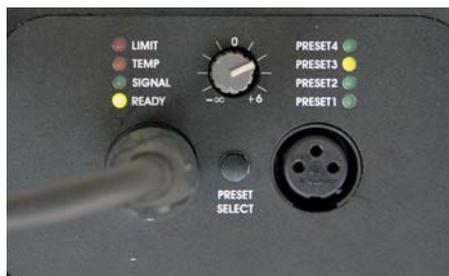
Bild 6: Einstellmöglichkeiten des Bassmoduls
