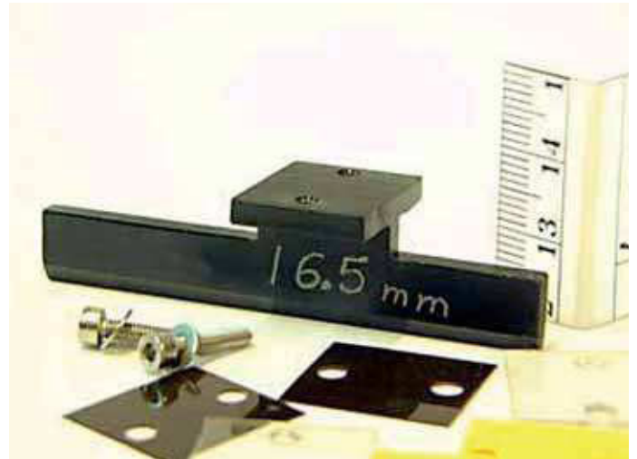
Wally bietet eine Reihe von Justierwerkzeugen zur Einstellung eines korrekten SRA an (Foto: www.wamengineering.com )
