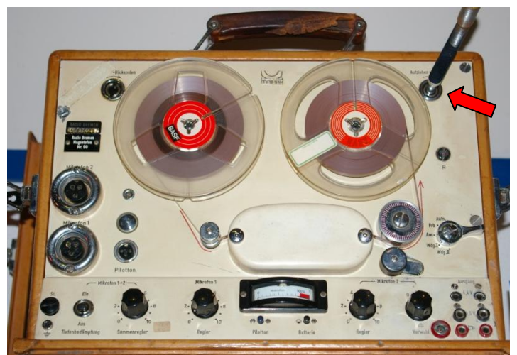
Baujahr 1958: Tonbandgerät Mähak Reportofon MMK 6 mit Federwerksantrieb zum Aufziehen (siehe roter Pfeil)
