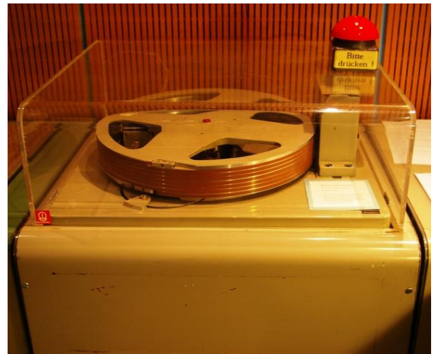
Baujahr 1952: Pausenzeichenmaschine R-79 der Firma RTI Nürnberg zur Wiedergabe der Pausenzeichenmodulation
