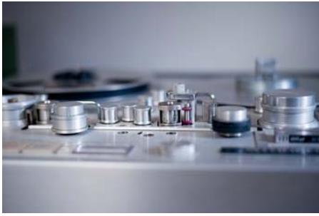
Für den Vinyl-Schnitt: Tonbandgerät Studer A80 Stereo 1/2 Zoll mit Previewkopf
