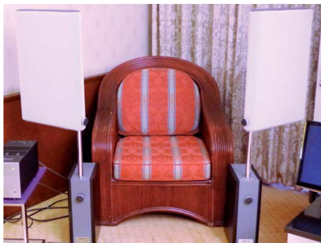
Elektrostatistischer Nahfeld-Abhörmonitor ESL Home von Sombetzki
