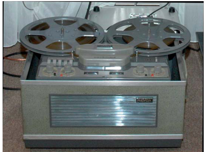
REVOX G36: Semiprofessionelle Koffermaschine mit Röhren
