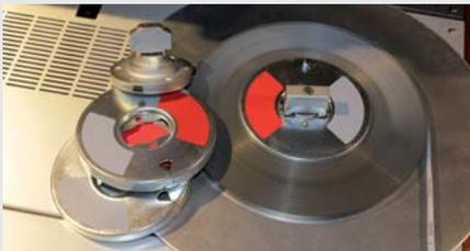
Bei nahezu allen Studiobandmaschinen, aber auch in der gehobenen Heimtonbandgeräteklasse findet der NAB-Adapter Anwendung.
