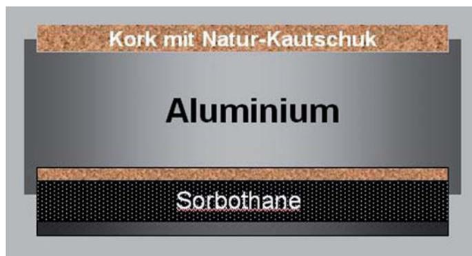
Bild 2: Absorber Schichtenquerschnitt\*
