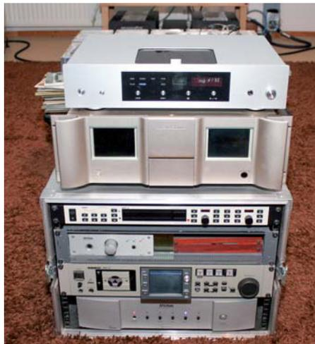
Als CD-Laufwerk kommt ein CEC »CD 5« zum Einsatz. Die digitale Aufzeichnung erfolgt über ein TASCAM »HS-2«, dem Fritz jedoch nicht die Analog-digital-Wandlung und umgekehrt überlässt. Die Digital-analog-Wandlung besorgt ein »Pavane« von METRUM ACOUSTICS und die Analog-digital-Wandlung wird über einen »ADC2« von DANIEL WEISS erledigt.
