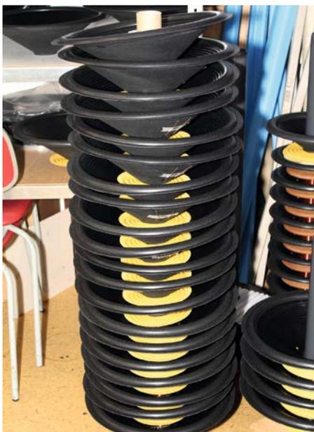
Bild 10: Stapel von Konus-Membranen vor der Montage in den Korb
