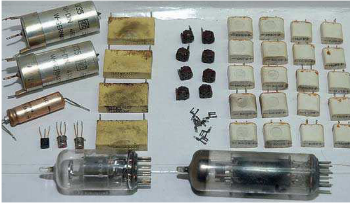
Ausgetauschte Bauteile nach der Restauration
