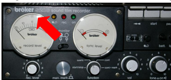
Filmtonmaschine von Bröker für Super 8-Magnetband auf Basis der UHER Report
