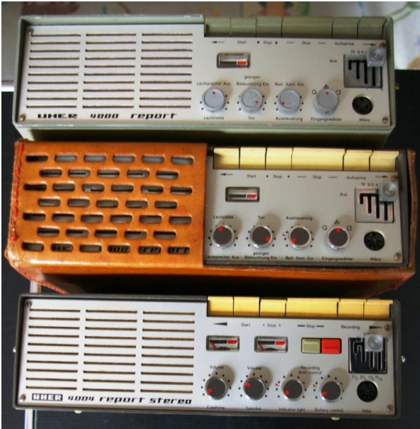
UHER Reporte Geräte aus den Anfangsjahren, erkennbar an den Aussteuerungsanzeigen
