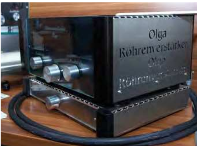
Radio Siegmann stellte mit dem „Olga Edition III“ einen auch optisch sehr ansprechenden Röhrevollverstärker vor. Der Preis liegt bei 3.500 Euro, die Ausgangsleistung an 8 Ohm beträgt 40 Watt.
